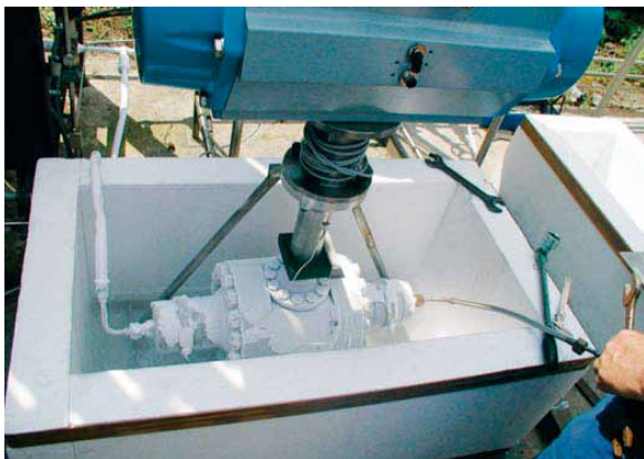
Kryogenische Prüfung – Kugelhahn NPS 4 Class 600
