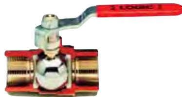
**LOGIC**-Kugelhähne haben eine von unten montierte Bedienungsspindel. Diese "ausblässichere" Spindel verhindert Beschädigungen und Verunreinigungen der Körperinnenteile (Kugel u. Kugeldichtungen) nach dem Einbau. Die Doppeldichtung besteht aus einer P.T.F.E.-Sicherungscheibe, die als Hochdruckdichtung und Antifrikationsring dient.
